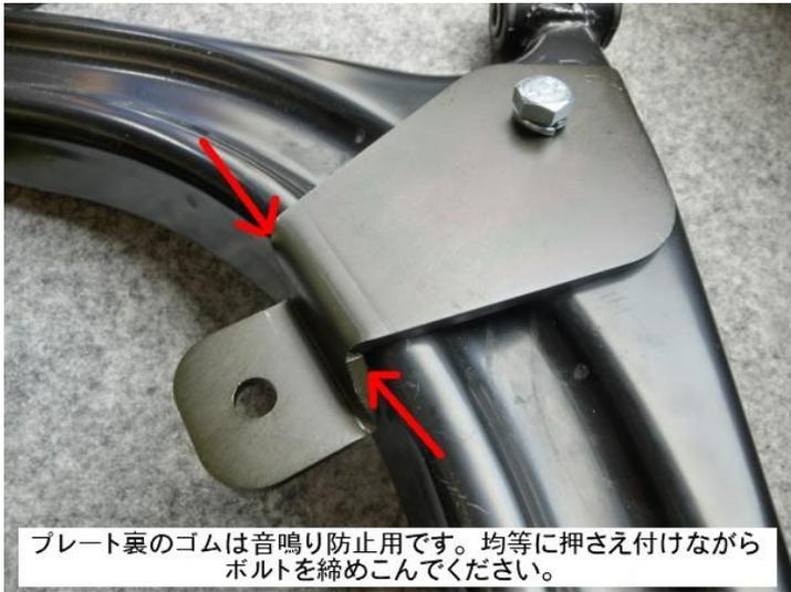
③プレートをロアアームにのせ、ボルト・ナットにて仮固定します。
