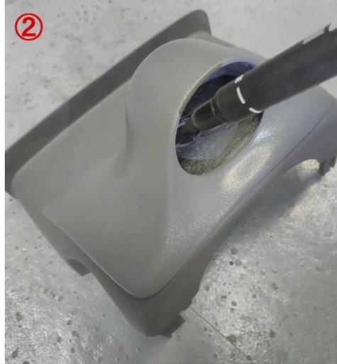
②コラムカバー上部を車両から取り外し、メーターカバーを仮置きします。この時点ではまだ固定はしません。油性ペンで穴あけ位置のセンターをマーキングします。
