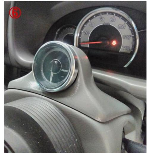
⑥メーターカバー裏面の両面テープの剥離紙を剥がし、運転席に座った状態でセンターを確認しながらコラムカバーに貼り付けてください。低温時はドライヤーで両面テープを温めると接着力が increases。※チルト調整付き車は最上部まで上げるとカバーに干渉します。
