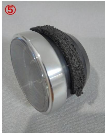
⑤付属のスポンジテープを追加メーターに貼り付けます。貼り付けやすいサイズにカットして使用してください。メーターカバーにメーターを差し込みしっかりと固定できるか確認してください。メーターがカバーの中で動く場合はスポンジテープを追加してください。
