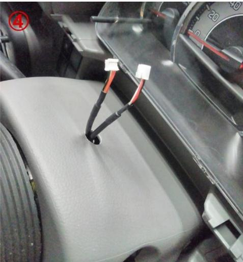
④追加メーターの配線を車両に結線し、コラムカバーを車両に取り付け、先ほど空けた穴から配線を出します。配線はステアリングの回転部分に干渉しないように注意して取り付けてください。
