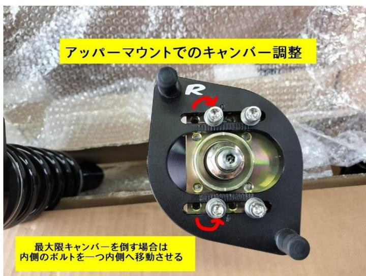
アッパーマウントでキャンバー調整を行う際は上部4か所のボルトを緩めます。(5mm六角レンチ) 取り外すのではなく、緩めるだけです。
