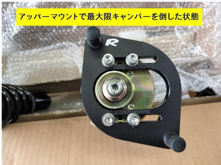
内側のボルト2本を移動させると、最大限キャンバーを倒すことができます。
